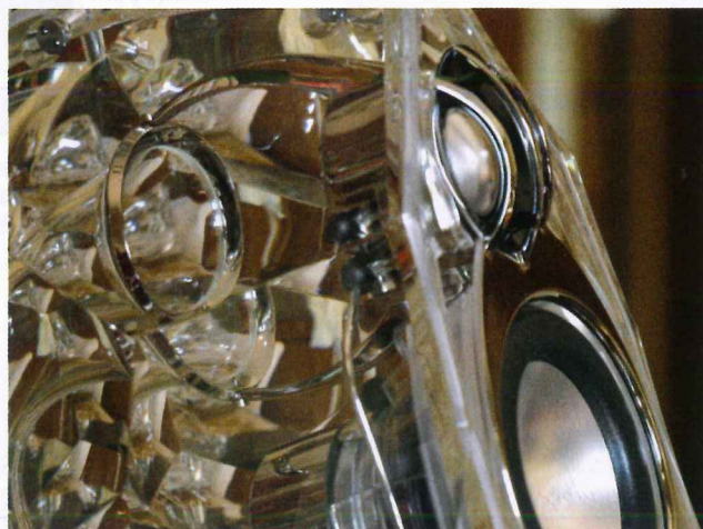
L'involucro del tweeter si prolunga, con due specie di pinne, fino all'imbocco del condotto reflex, al quale è avvitato. Le palline nere nascondono i faston dei terminali degli altoparlanti.
